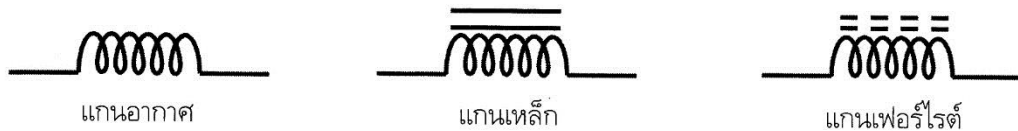
ภาพ สัญลักษณ์แทนโช้กแกนอากาศ แกนเหล็ก และแกนเฟอร์ไรต์
