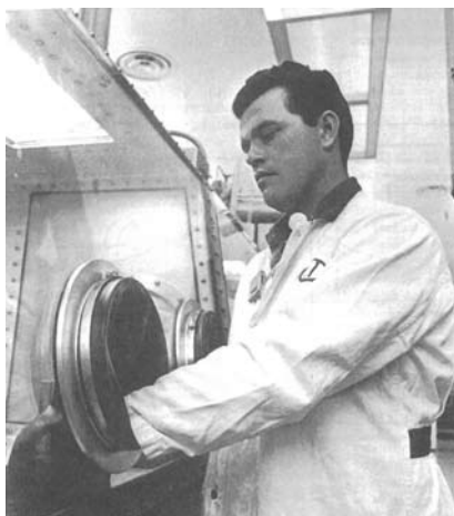
ภาพที่ 1.2 การปิดคลุมกระบวนการผลิตที่เป็นอันตราย และมีช่องให้ผู้ปฏิบัติงานสามารถเอามือสอดลงไปในถุงมือเพื่อทำงานได้ (air box)
